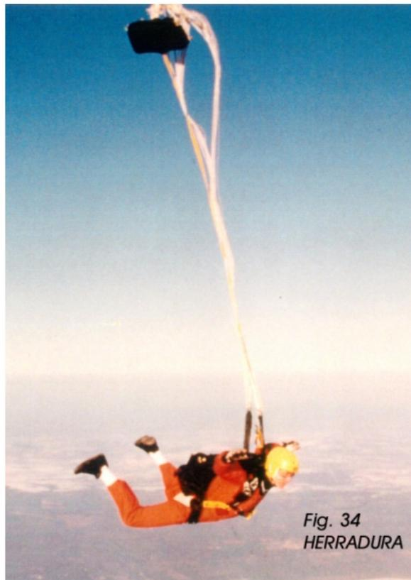
9.6.4.2 El pilotillo, la brida u otra parte del paracaídas se han enganchado en alguna parte del arnés o en el cuerpo del paracaidista y aunque salen los cordones incluso la tela de la campana, ésta no se puede abrir correctamente. (Fig.35)
